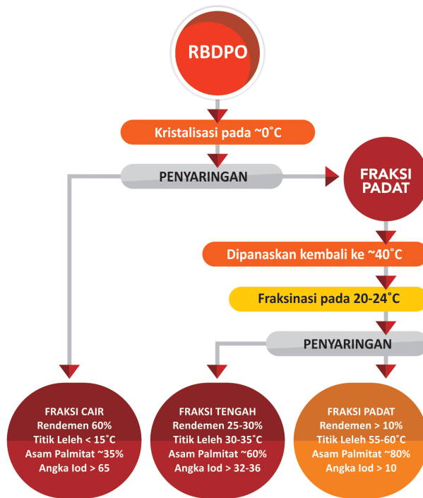
Gambar 4. Proses fraksinasi lanjut Refined Bleached Deodorized Palm Oil (RBDPO) menjadi tiga bagian minyak sawit dengan sifat fisika berbeda
